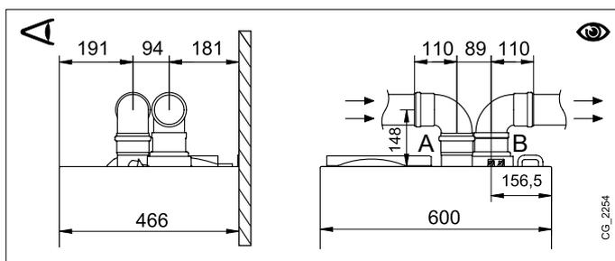
90° відвід дозволяє приєднувати котел до димоходу-повітроводу в будь-якому напрямку, адаптуючись до різних потреб. Крім того, він може використовуватися в якості додаткового в поєднанні з трубою з 45° відводом.
